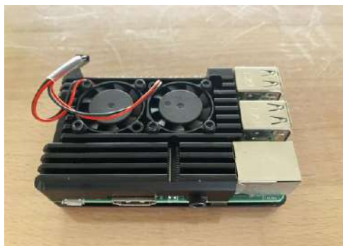
Рисунок 4. Мини-компьютер Raspberry Pi 3 с установленной системой охлаждения
