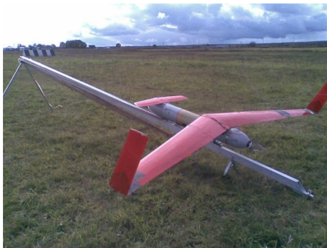
Рисунок 2. БПЛА самолетного типа, запуск с катапульты
