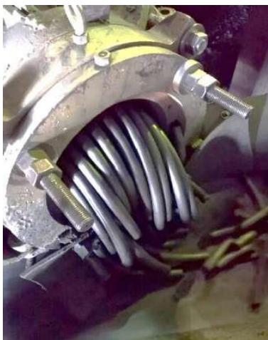
Рисунок 1 – Процесс окускования методом экструзии
