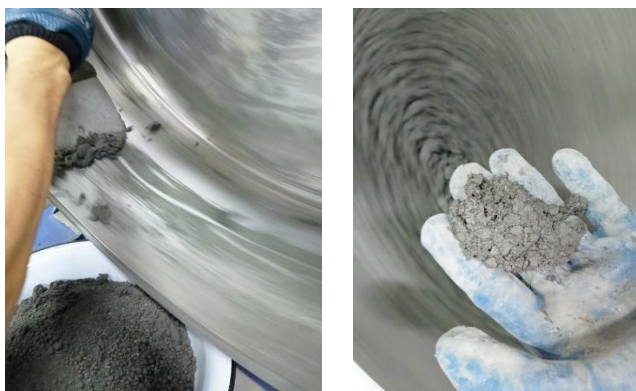
Рисунок 3. Процесс окатывания при использовании связующего ПАА и ЕВ в количестве 1-2%
