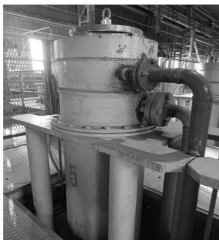
Рисунок 3. Устройство и внешний вид классического СВС-реактора объёмом 0,15 м 3 .
