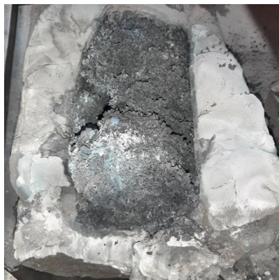
Рисунок 1. Схема проведения СВС-процесса во внешней химической печи (слева) и фотография его практической реализации (справа)
