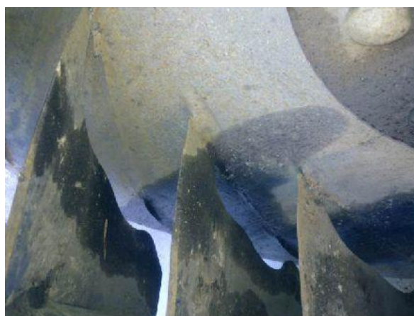
Рисунок 7 – Эрозионный износ лопаток рабочего колеса
