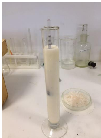
8-сурет. Сүттің тығыздығын ареометрмен өлшеу
