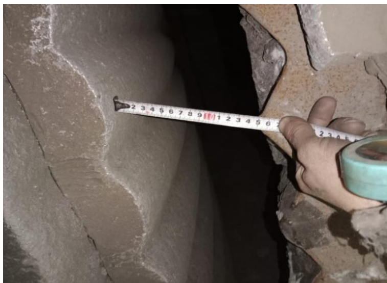
Рисунок 4 – Процесс регулировки зазора СМД-111
