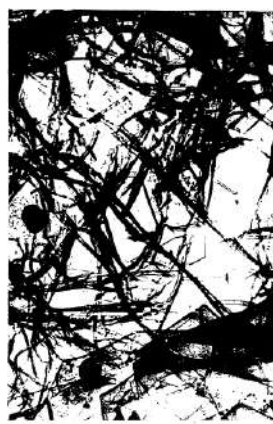
Рисунок 3 –Микрофотография кристаллов ксонотлита
