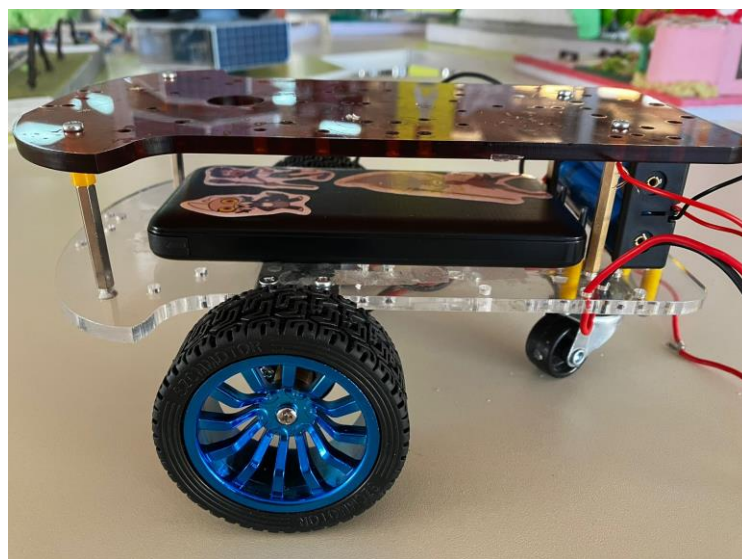
Рисунок 11. Блоки питания, установленные на платформу
