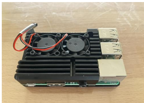
Рисунок 4. Мини-компьютер Raspberry Pi 3 с установленной системой охлаждения
