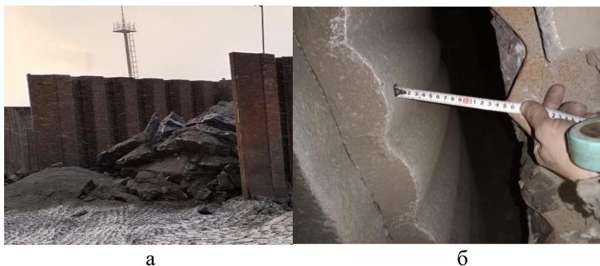
Рисунок 2. Хранение исходных слитков ВУФХ (а) и регулировка зазора СМД-111 (б)
