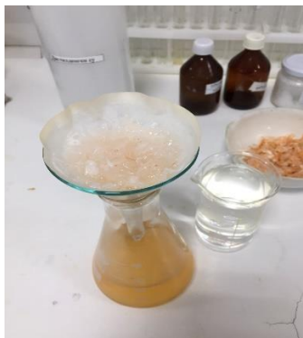
6-сурет. Сілтімен деацетилденген өнімді сүзу
