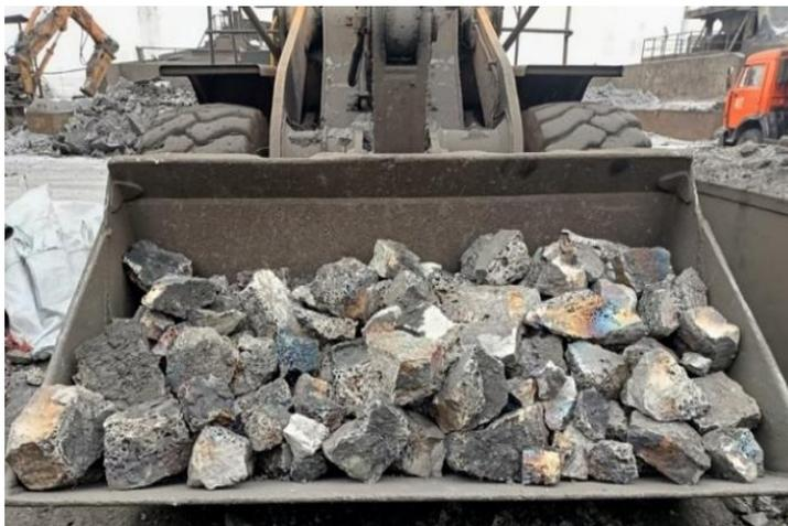
**Рисунок 5 – ВУФХ перед погрузкой в бункер дробилки СМД-111**
