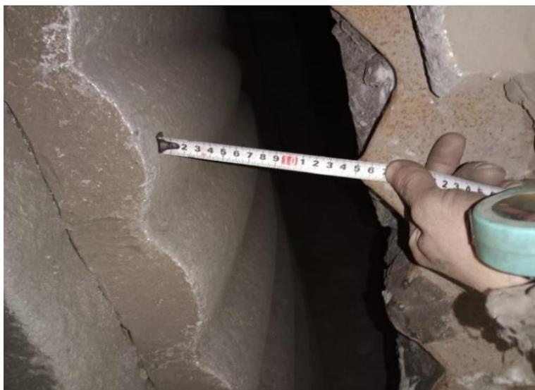
**Рисунок 4 – Процесс регулировки зазора СМД-111**
