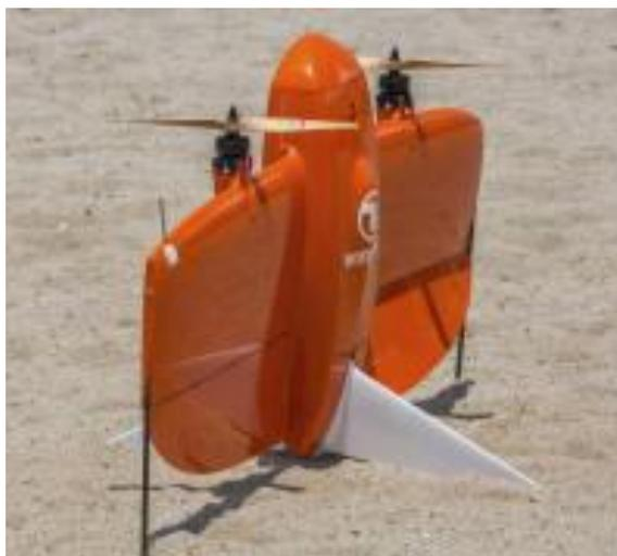
Рисунок 3. WingtraOne — конвертоплан
