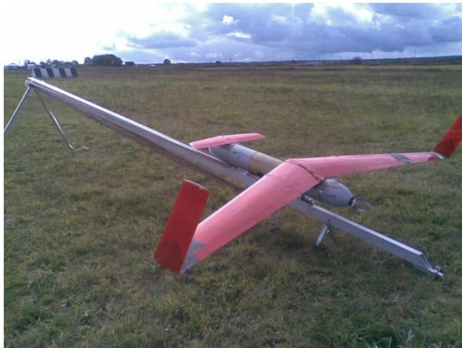
Рисунок 2. БПЛА самолетного типа, запуск с катапульты
