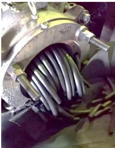
Рисунок 1 – Процесс окускования методом экструзии
