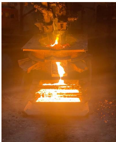
Сурет 5 - Пештен металл мен қожды шығару
