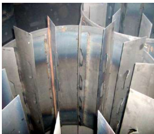
Сурет 1. Кен термиялық электр пеші электрод қабықшасының бөліктері
