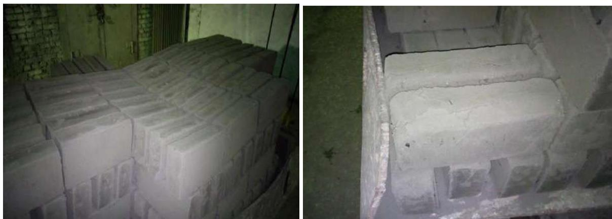
**Рисунок 1. Сырые сбрикетированные кирпичи из аспирационной пыли в смеси с рукавной пылью, жидким стеклом и полипропиленового волокна**
