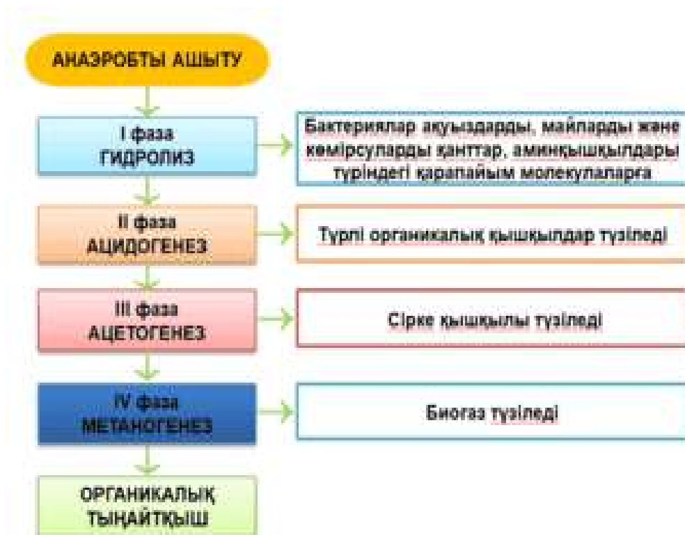
4 – Сурет. Метаногенез процессінің схемасы
